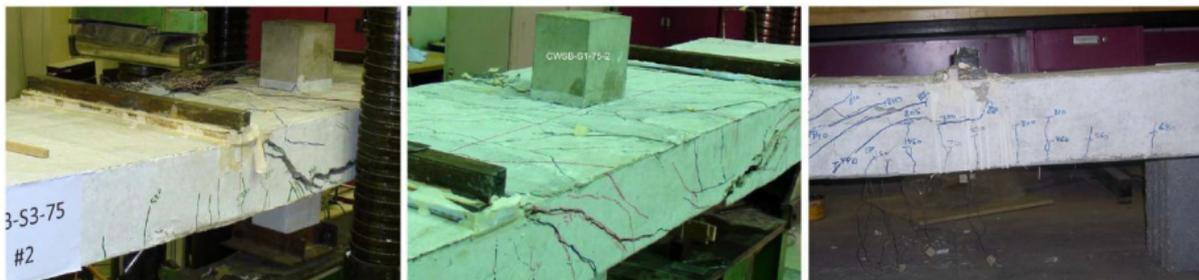
Figura 2.18 – Padrão de ruptura em vigas faixas ensaiadas por SHURAIM & AL-NEGHEIMISH (2012)
